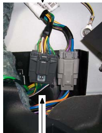
PIN 17 FILO ARANCIONE/GIALLO SEGNAL PWM POMPA BENZINA
