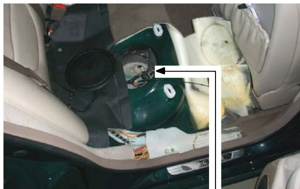
CENTRALINA COMANDO POMPA BENZINA SITUATA SOTTO AL SEDILE POSTERIORE LATO PASSEGGERO
